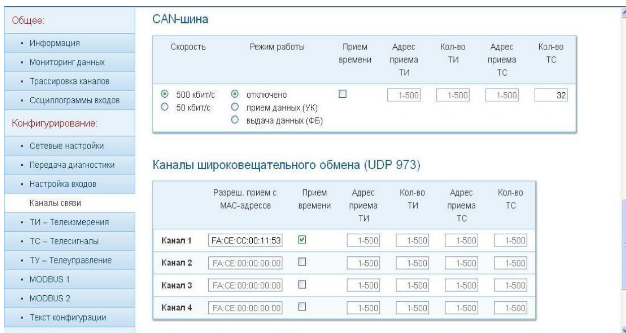
Рисунок 16 – Вид закладки для работы с CAN-шиной
